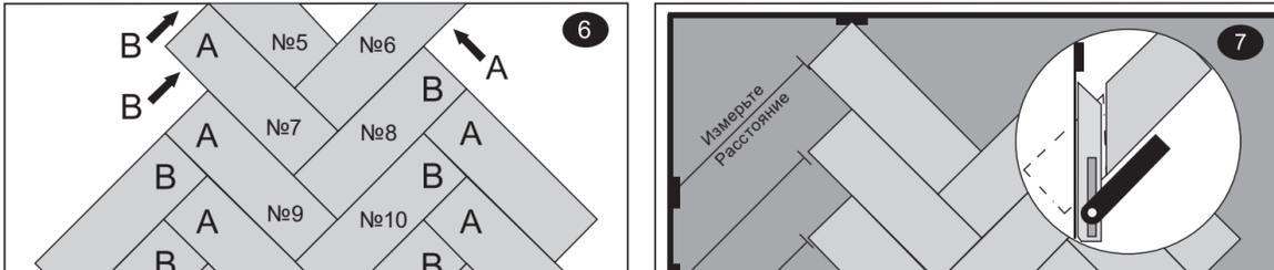
Продолжайте устанавливать планки «А» и «В», пока не понадобится отрезать планки, чтобы они примыкали к стенам помещения. Расстояние от досок до стен с противоположных сторон помещения рекомендуется делать одинаковым. Обрезае доски, которые подходят к стене, оставляйте температурный зазор 8-10 мм (12-15 мм в случае использования совместно с системами «теплый пол»). Используйте угломер, чтобы обрезать доски под идеальным углом (рис. 7).
